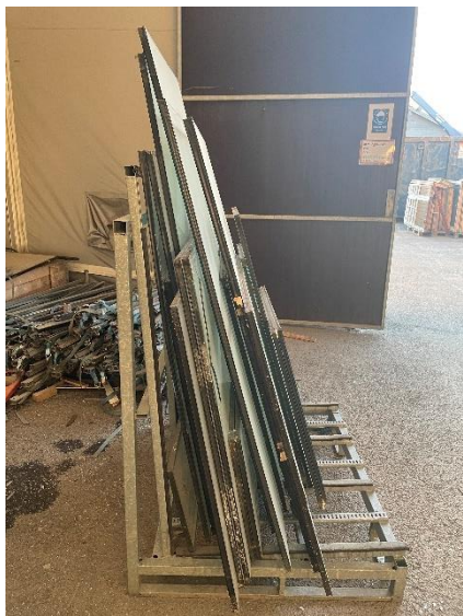
Bilde 1 viser isolerglassruter uten ramme, med isolerglasslim tilgjengelig for prøvetaking. Tapetkniv med rent knivblad ble brukt for å skjære ut tilstrekkelig mengde isolerglasslim til analyse.
