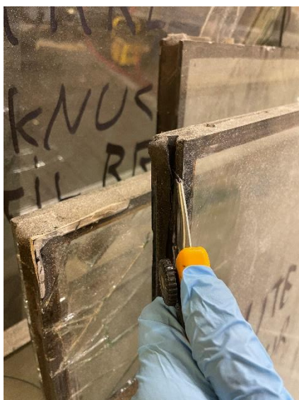
Bilde 2 prøvetaking av isolerglasslim.
