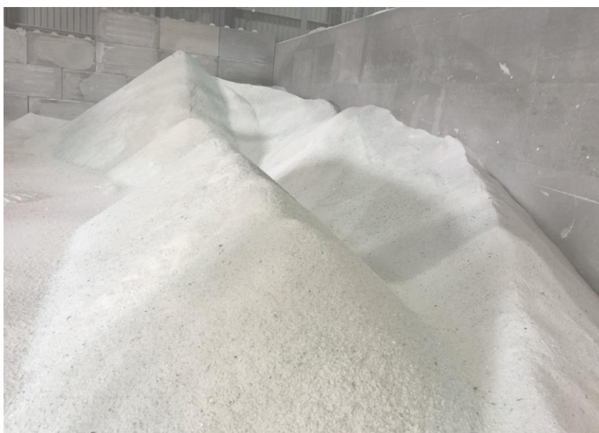
Bilde 1 viser nedknust glass etter at det er tatt ut fra kasserte vinduer. Glassgranulatet erstatter jomfruelig glass når det blir til isolasjon hos Glava. Foto: Ruteretur.
